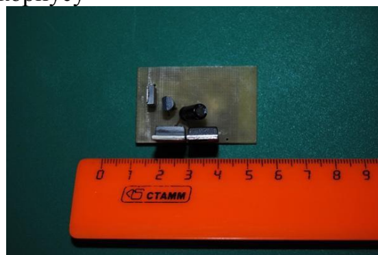
Рисунок 4 – Регулятор частоты вращения с электродвигателем, подключенным к корпусу
